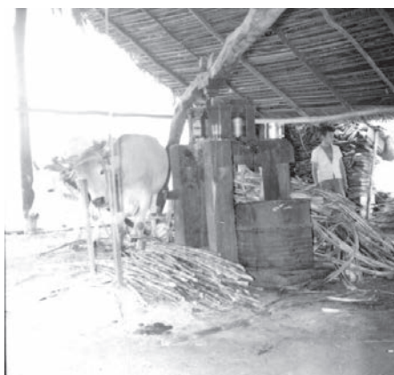
Foto 14 - Fabricação de rapadura. Porto Velho (RO). Foto: Osvaldo Gilson Fonseca Costa e Orlando Valverde, 1968. Acervo fotográfico do IBGE.
