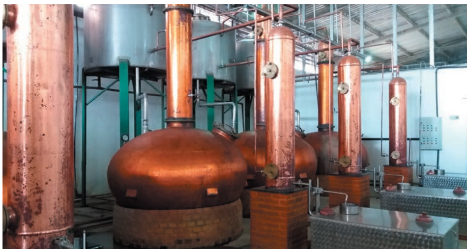
Foto 16 - Alambique de cobre utilizado na produção de cachaça artesanal. Trabalho de campo: Daiane de Paula Ciriáco, 2017.
