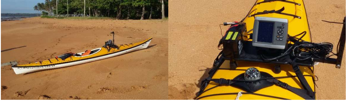
Figura 2.19. Caiaque com ecobatímetro acoplado com GPS.
