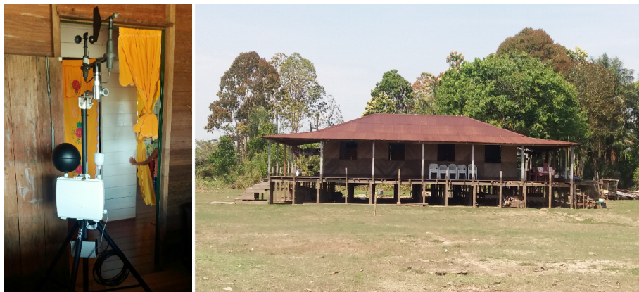
Figura 5: Estação meteorológica automática portátil e casa da tipologia palafita ribeirinha analisada. Fonte: Dos autores.
