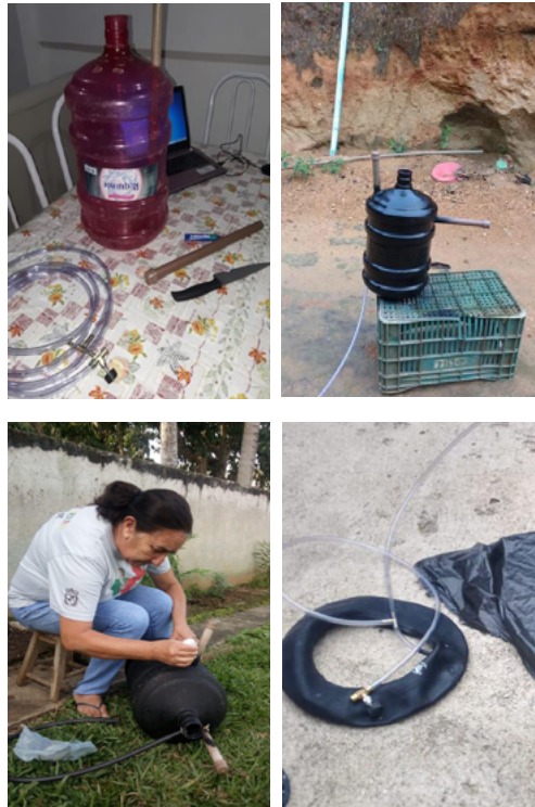
Figura 3 – Etapas da construção do biodigestor
