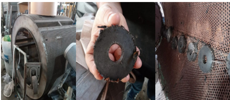
Figura 7. Rotor cilíndrico perfurado e sistemas de ímãs para separação de metais, em sequência.
