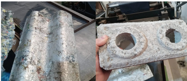
Figura 2. Corpos de prova feitos a partir de plástico reciclado.
