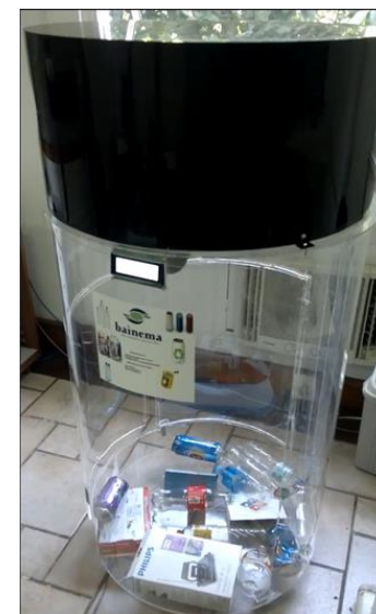
Figura 18 - Lixeira Inteligente - Placa de circuito eletrônico impresso, Display Lcd Gráfico 128x64, Sensor de Ultrassom 40KHz (Par RX e TX), Árvore de decisão
