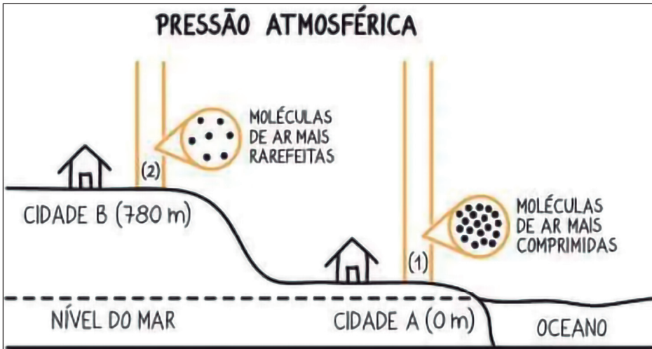
Figura 56 – Ilustração da variação da pressão atmosférica exercida do por diferentes colunas de ar
