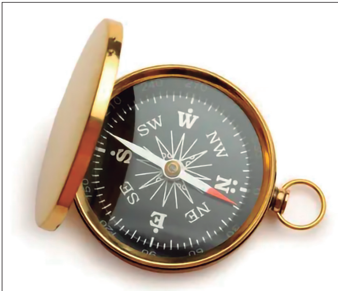
Figura 9(b) – Bússola é um instrumento de navegação e orientação baseado em propriedades magnéticas dos materiais ferromagnéticos e do campo magnético terrestre
