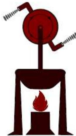
**Figura 1.1:** Desenho esquemático da Eolípila de Heron.
