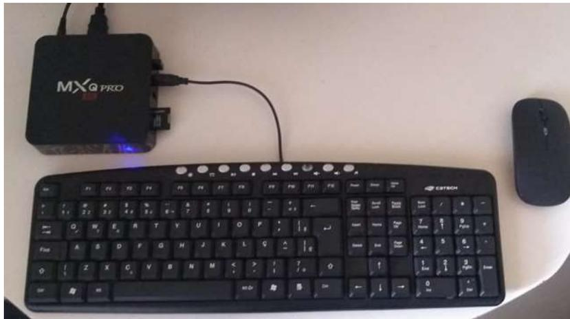
Figura 4: Teclado, mouse e HDMI do monitor conectados na TV box
