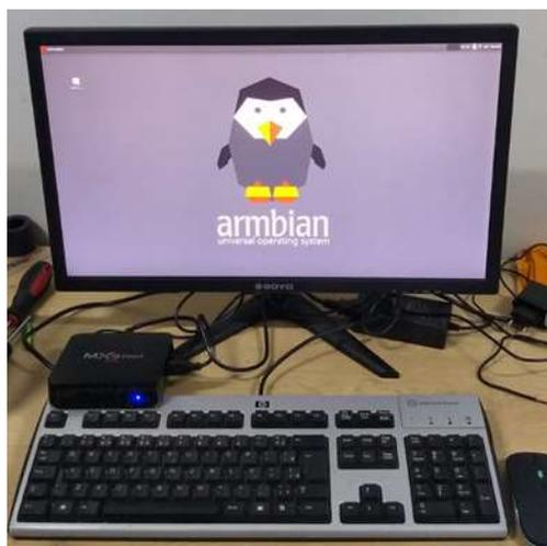
Figura 6: Tela inicial do linux instalado na TVbox
