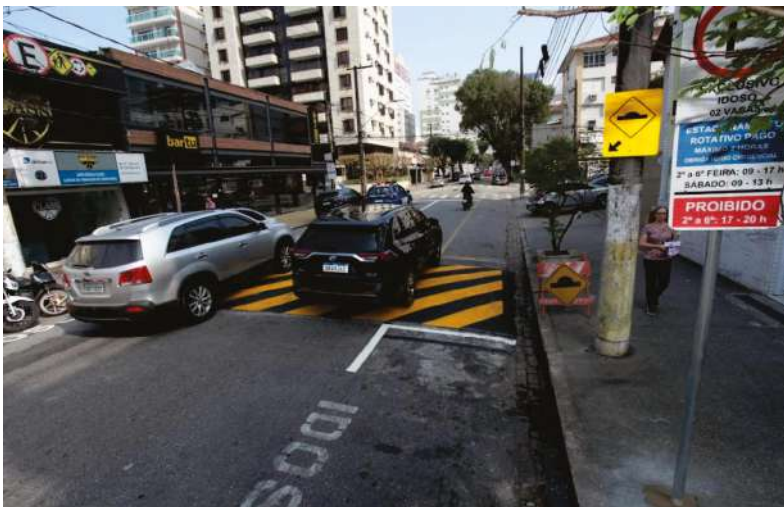
Figura 5 – Medidas Moderadoras de Tráfego: Lombadas (Deflexão vertical)
