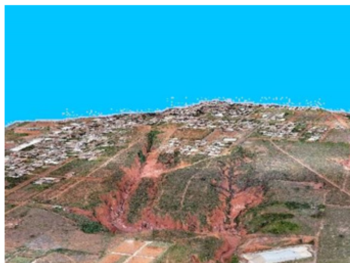
Figura 5 - Visualização tridimensional, a partir de mapeamento com drone, de processo erosivo intenso ocorrido no município de Cristalina-GO
