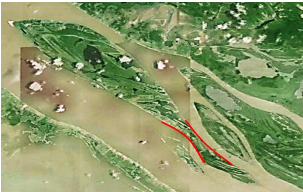
Figura 3: Margens côncavas onde atualmente se concentram os processos erosivos na comunidade Ilha Grande.
