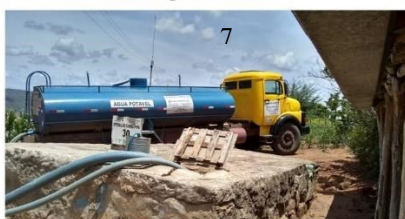
Cisterna de pedras sendo abastecida pela operação pipa
