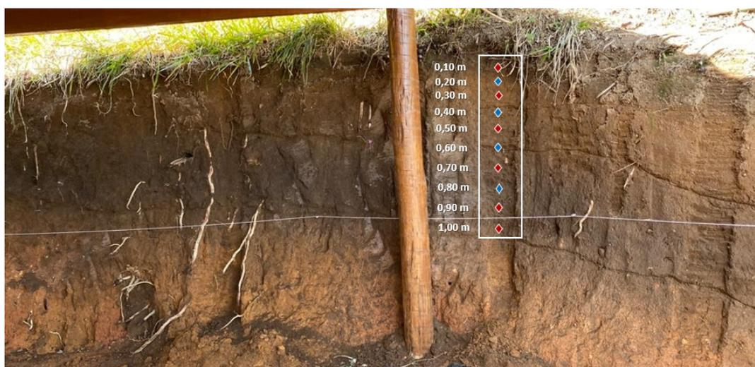
Fig. 2. Perfil estratigráfico de coleta dos testemunhos. As marcações em vermelho indicam as profundidades datadas e as em azul os níveis de análise não datadas.
