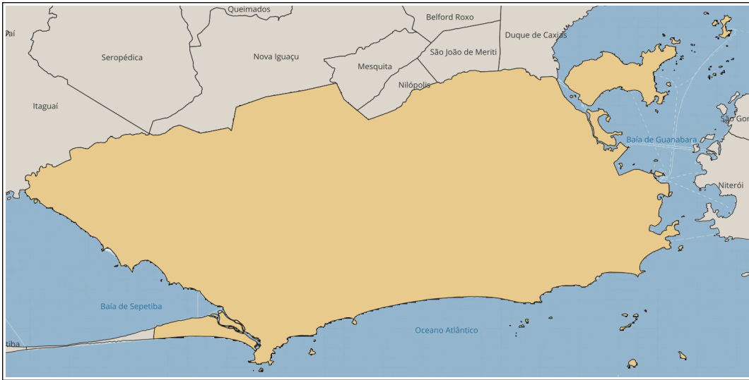
Figura 221 – Resultado após a dissolução dos polígonos de bairros – gerado apenas um polígono representando o município
