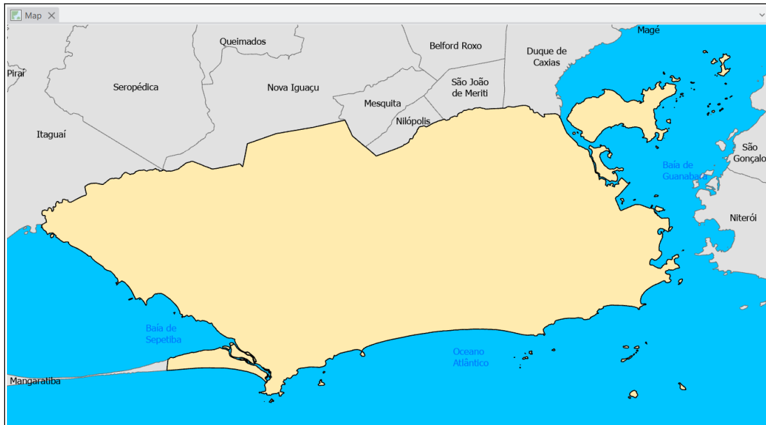
Figura 210 – Resultado da aplicação de DISSOLVE, fundindo as feições dos bairros do Rio de Janeiro em um único polígono – limite do município
